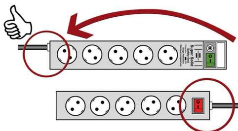
Image d'utilisation, câble à l'opposé de l'interrupteur
