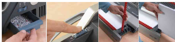
Tiroir à cOnfettis - butée réglable - Bac de rangement retirable avec mécanisme de mesure
